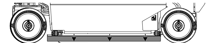
Platvorm täielikult üles tõstetud – löökaugukaitstesüsteemi ribad on täiesti all
