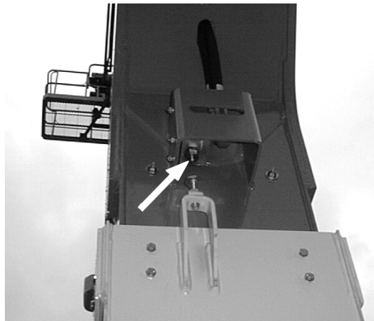
Joonis 2-6. Samba noole horisontaalne piirlüliti
