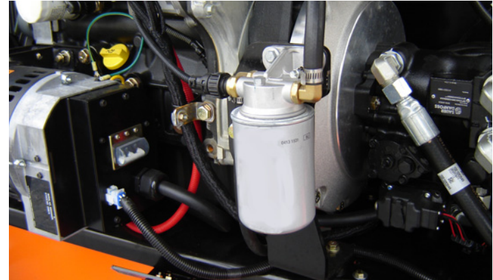
B. Kütusefilter - Deutz TD 2,9 (mootoril)
