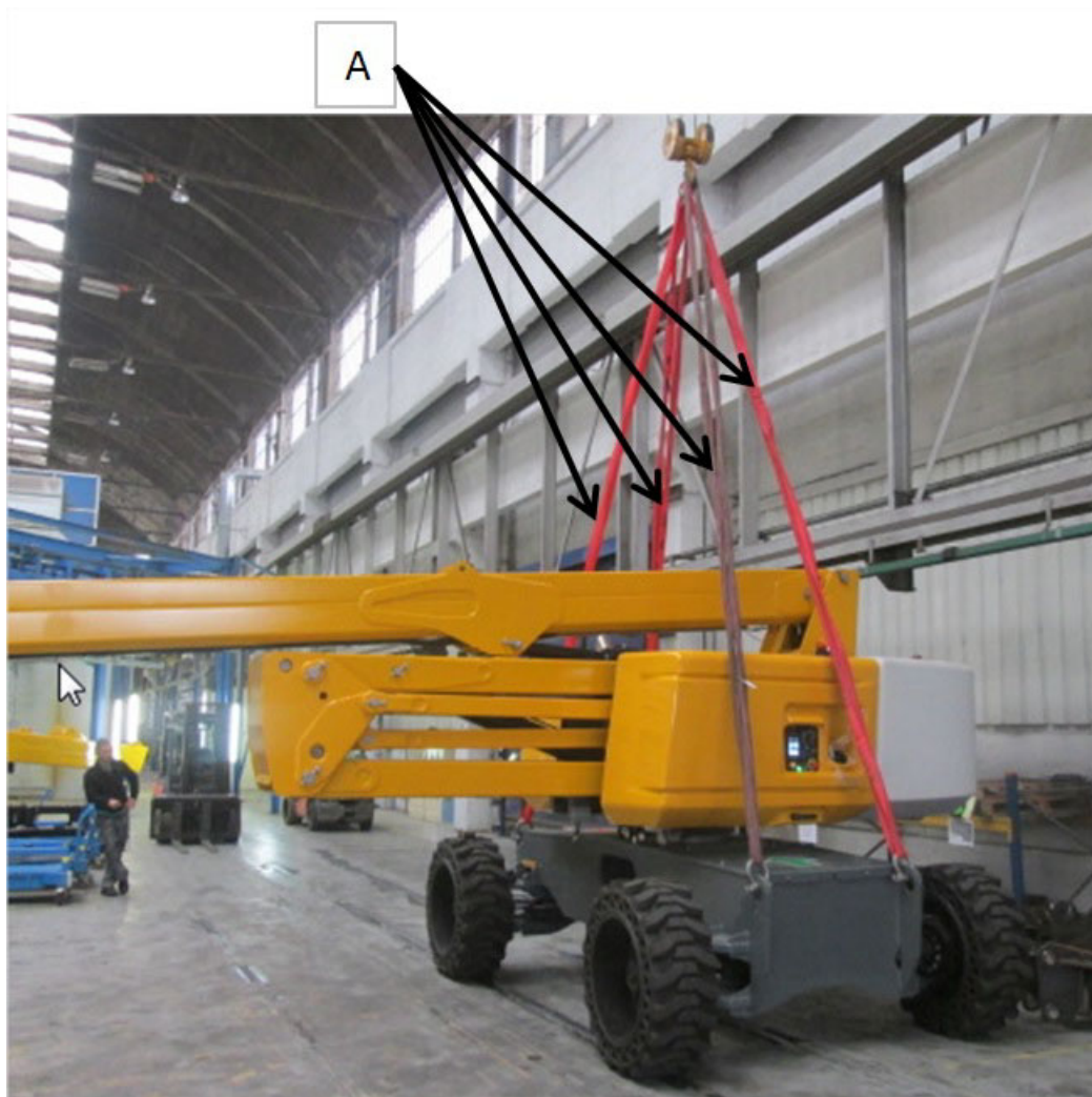
Схема подъема на стропах
