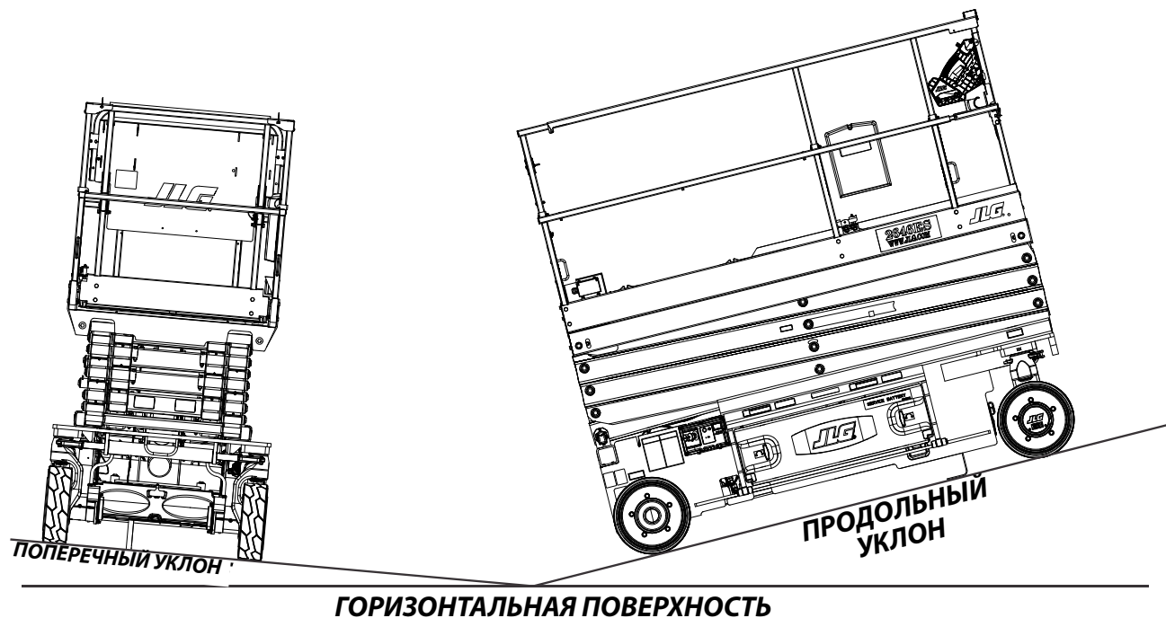
Рис. 3-5. Продольный и поперечный уклоны во время движения с платформой в транспортном положении
