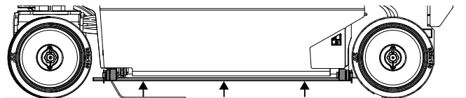
Платформа опущена — штанги системы защиты от ударов при попадании в выбоины подняты
