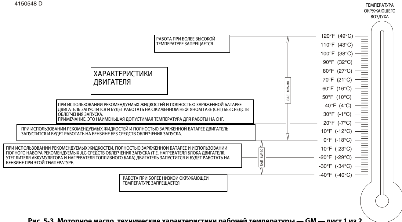
Рис. 5-3. Моторное масло, технические характеристики рабочей температуры — GM — лист 1 из 2
