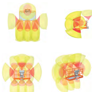
Рис. 40. Зоны покрытия уровня 2 SkySense (3 штанги)
