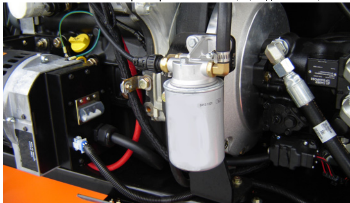
С. Топливный фильтр — Deutz TD 2,9 (на двигателе)
