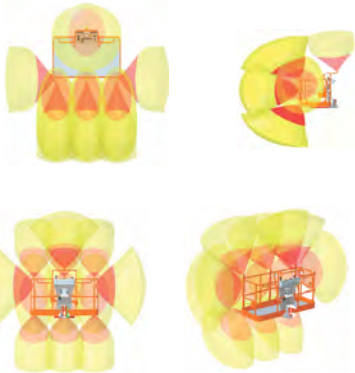
Рис. 20. Зоны покрытия уровня 2 SkySense (3 штанги)
