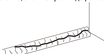
Трещина сварного шва
